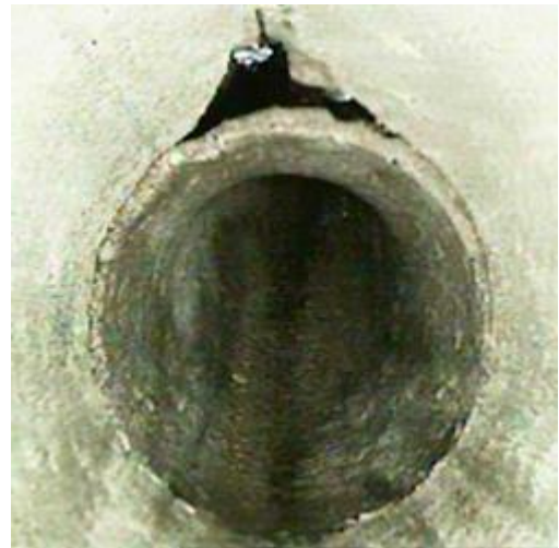
| Det er typisk huller som disse der kan klares med en strømpeforing
